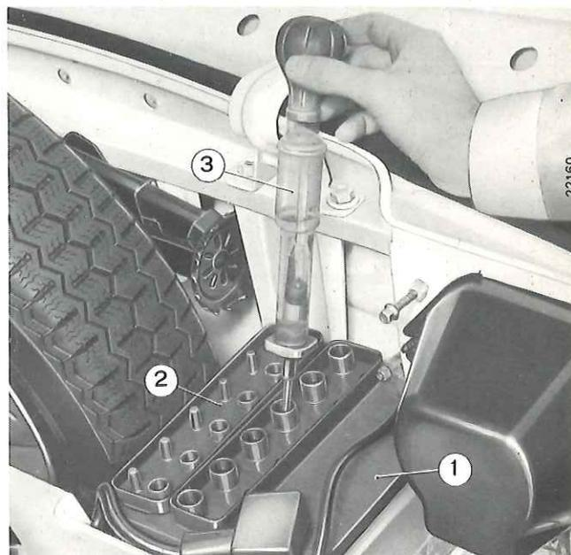
Messen des Ladezustandes der Batterie mit dem Dichtmesser A. 95852.
