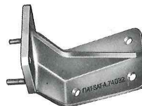
A. 74032 Halter für Lenkgehäuse bei der Überholung.
