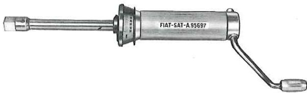
**A. 95697** Dynamometer zur Kontrolle des Rollmoments der Hinterradlager.
