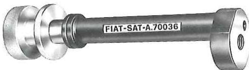
**A. 70036** Messdorn zur Bestimmung der Stärke der Einstellscheiben des Antriebskegelrades, zu verwenden mit der Messuhr **A. 95690**.
