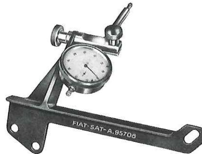
**A. 95708** Vorrichtung zur Einstellung des Spiels zwischen Tellerrad und Antriebskegelrad.
