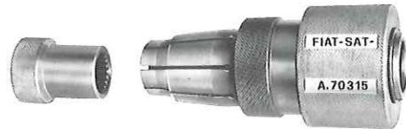
**A. 70315** Werkzeuge zur Kontrolle des Rollmoments der Differentiallager, zu verwenden mit **A. 95697**.
