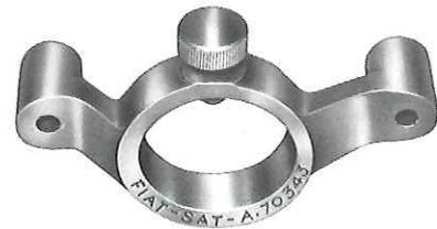
**A. 70343** Werkzeug zum Festhalten der 2. Gang-Schaltmuffe und des Antriebskegelrades beim Abmessen des Spiels zwischen Kegelrad und Tellerrad.
