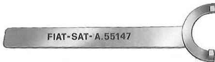
**A. 55147** Schlüssel für Einstellmuttern der Differentiallager.
