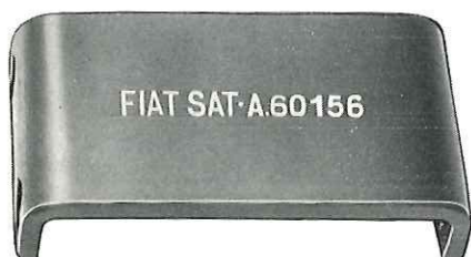
A. 60156 Halter für Zylinder beim Kippen des Motors am Überholungsbock.
