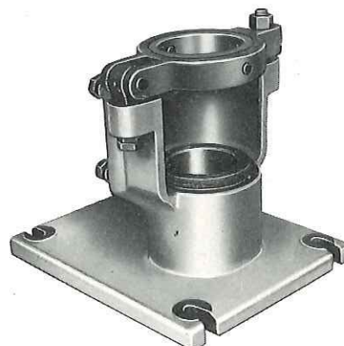
A. 60027 Werkzeug mit Zentrierring ( 60027/19 ) zum Einspannen der Zylinder beim Nach- schleifen.
