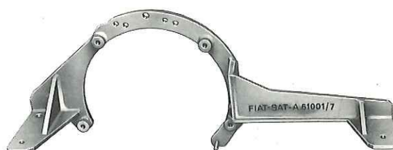
A. 61001/7 Stütze zur Befestigung des Motors am Drehbock Ar. 22204 .
