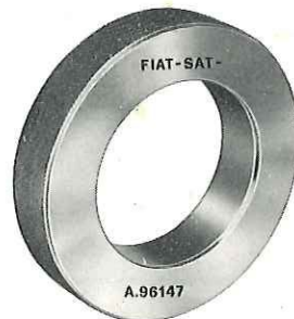
A. 96147 Ringlehre (Ø 73,5 mm) zur Nullstellung der Messuhr A. 95687 .
