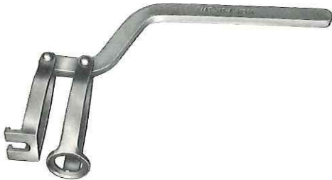
A. 60084 Werkzeug zum Aus- und Einbau der Ventile.
