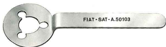
A. 50103 Schlüssel zum Festhalten der Riemen- scheibe beim Aus- und Einbau der Lichtmaschine und des Luftgebläses.
