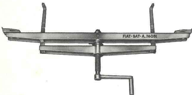
A. 74061 Spannvorrichtung der Blattfeder.
