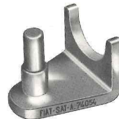
A. 74054 Halter für Querlenker der Vorderradaufhängung beim Abziehen der elastischen Büchsen.
