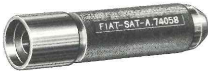
A. 74058 Treibdorn zum Einbau der Querlenker-Büchsen.
