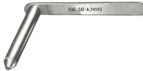
A. 74143 Führungsdorn zum Einbau der Einstell-scheiben am Hinterradlenker.
